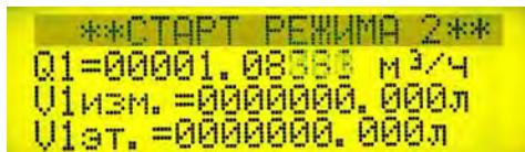
С приходом первого импульса от поверяемого счетчика / первого импульса от радио-брелка установка начнет вычислять значение объема воды, прошедшей через эталонный преобразователь расхода – **V1эт.** С приходом каждого импульса от поверяемого счетчика / радио брелка (кроме последнего импульса, по которому поверка автоматически закончится) значение **V1изм.** будет увеличиваться на величину веса импульса поверяемого счетчика
