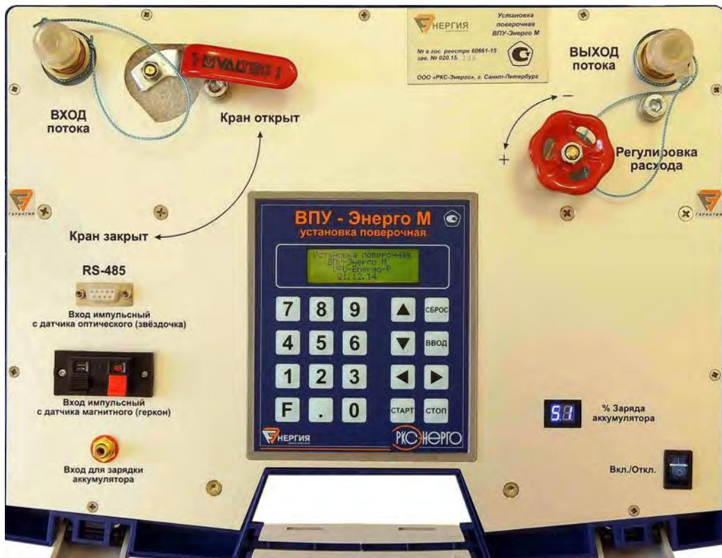
Рисунок 2 – Лицевая панель установки
